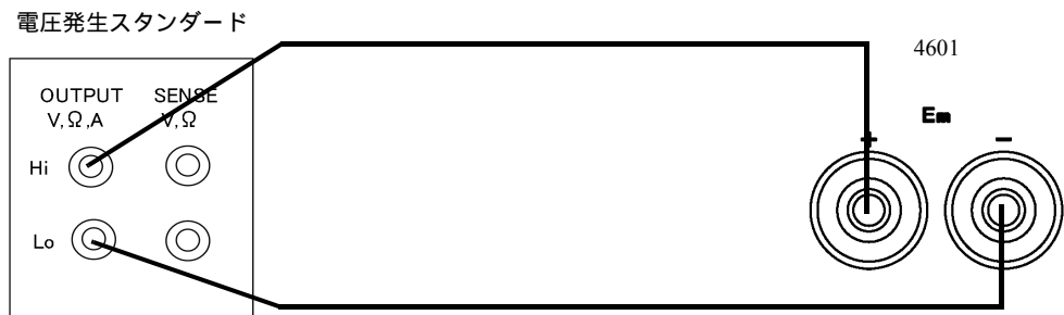
(j) 外部電圧測定校正の接続
