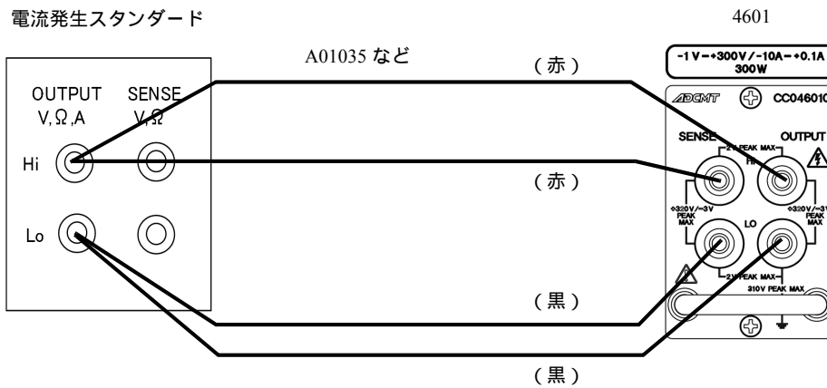
(b) 電流測定校正（300 \mu A ~ 300mAレンジ）の接続
