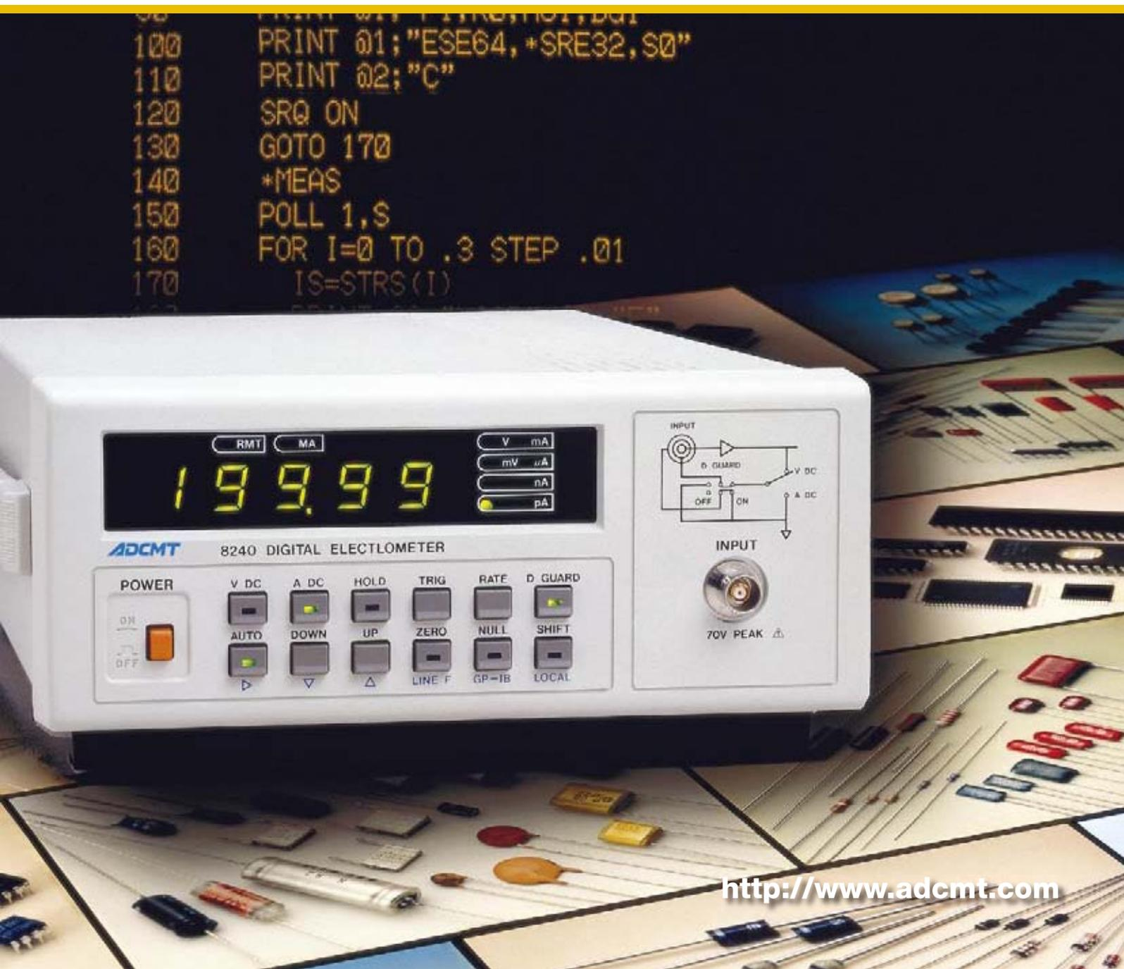
8240は、 $10^{13}\Omega$ 以上の高入力インピーダンス電圧測定と、10fAから20mAまでワイド・レンジな電流測定ができる4½桁の低価格デジタル・エレクトロメータです。材料の基礎研究、半導体・電子部品の評価試験・選別、新素子の研究・開発、あるいは分析、生体関係など、広い用途に使用できます。また使い易い機能として、約25回/秒(50Hz)、約28回/秒(60Hz)の高速サンプリング、オフセット電圧や暗電流などを自動的にキャンセルして、正確な測定ができるヌル機能、高感度レンジにおける外部ノイズなどの影響に対しては、A/D変換器の積分時間を7段階に設定できる可変積分機能などがあります。とくに、システム用として便利なGPIBインタフェースを標準で装備しています。
