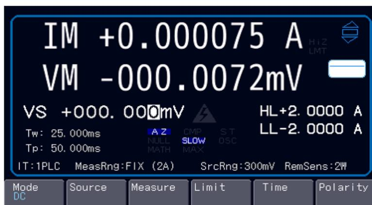
図 1-10 VSIM 測定の表示（出力 ON）
