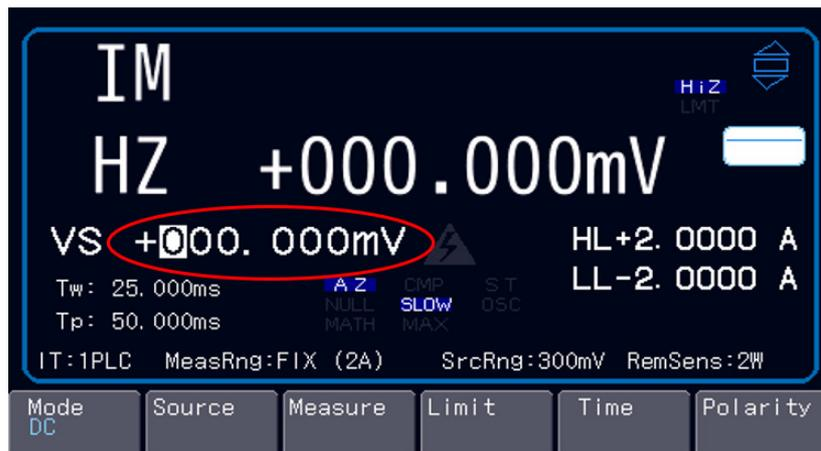
左右キーでカーソルの移動、ロータリ・ノブを回すと数値の増減と極性の切り換えができます。
