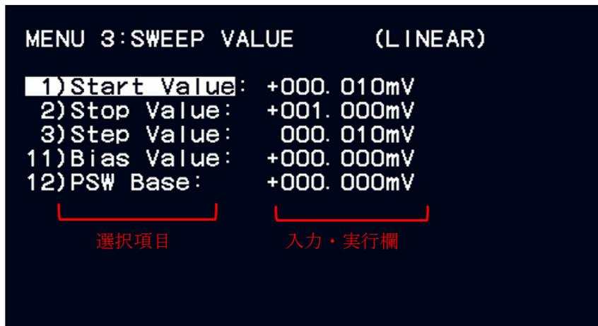
Sweep Value 階層の項目（左側：選択項目）をロータリ・ノブで選択します。
